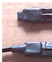
Vaihe 6: Kuumenna kutistesukka kuumailmapuhaltimella. Varmista tiivistys painamalla pinnat vastakkain työkalulla.
